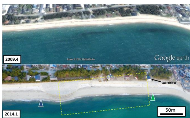
図-2 養浜前後における室積海岸地形の比較と、着色砂投入地点(青および緑の三角.)
