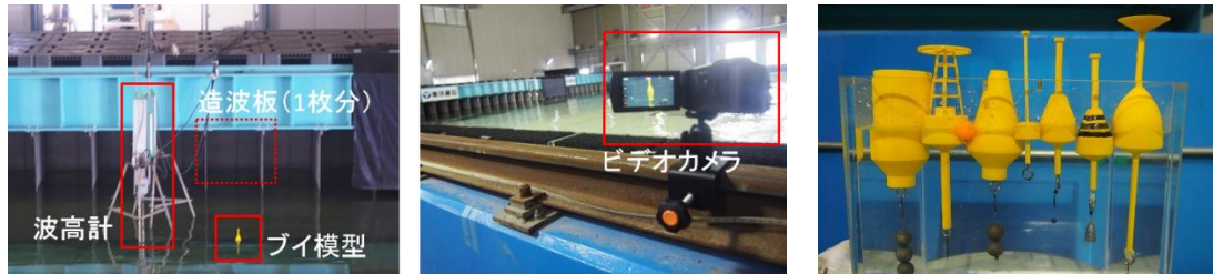
図-3 造波水槽における実験状況 (左: 波高系と浮標模型, 中: 浮標撮影設定, 右: 浮標模型)
